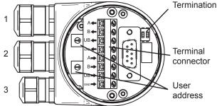
Cable: 1, 2 =  $\emptyset$ 8-10 mm (-40-85 °C) /  $\emptyset$ 5-9 mm (-25-85 °C) Cable: 3 =  $\emptyset$ 4.5-6 mm (-40-85 °C) /  $\emptyset$ 3-6 mm (-25-85 °C)
